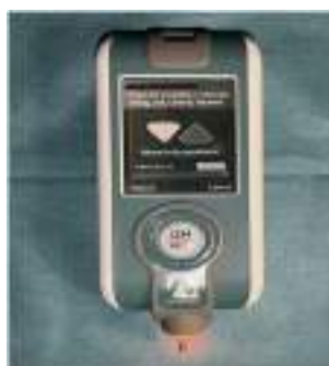
الشكل (3) يوضح جهاز MyotonePRO المستخدم في البحث
